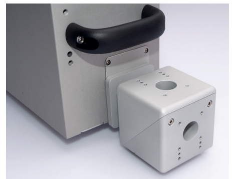
带有分束器立方体的过程监控端口
